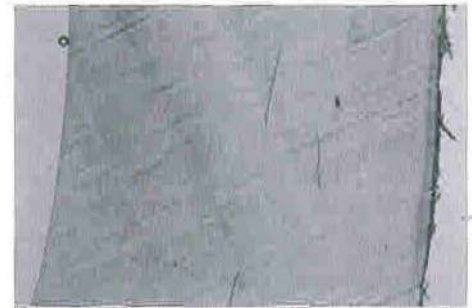
Bild 11: Querschnitt durch die Rohrwand der Probe Nr. 15 mit Rissen parallel zu den Oberflächen und geschädigter Außenoberfläche. Durchlicht aus Mikrotomschnitt, Vergr. 25 : 1.
