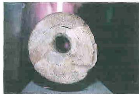
Bild 6: 1992 unter dem Marktplatz gefundenes etwa 130 Jahre altes Holzrohr aus der zwischen 1562 bis Mitte des 19. Jahrhunderts genutzten Wasserleitung von Bitterfeld.
